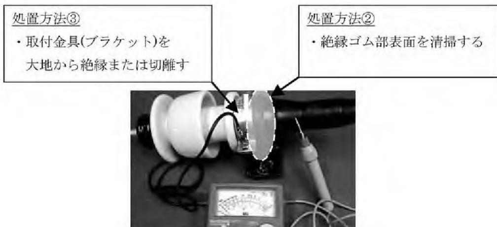
写真2 耐塩害終端接続部の処置例
